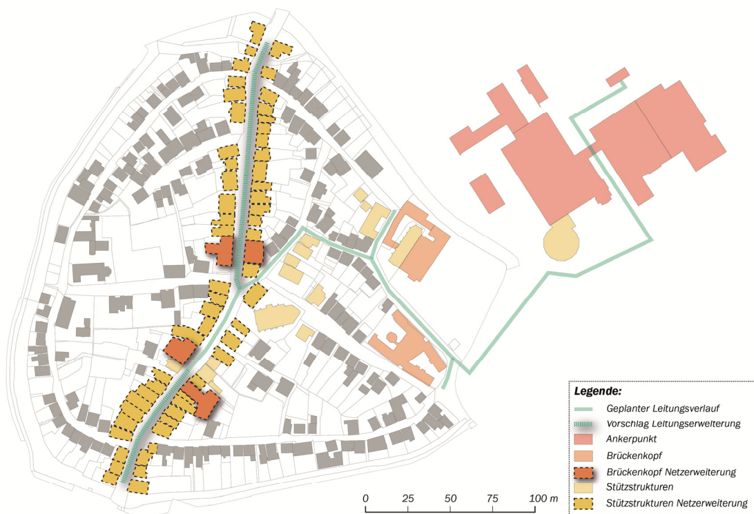
Abbildung 50: Mögliche Erweiterung des Nahwärmenetzes
