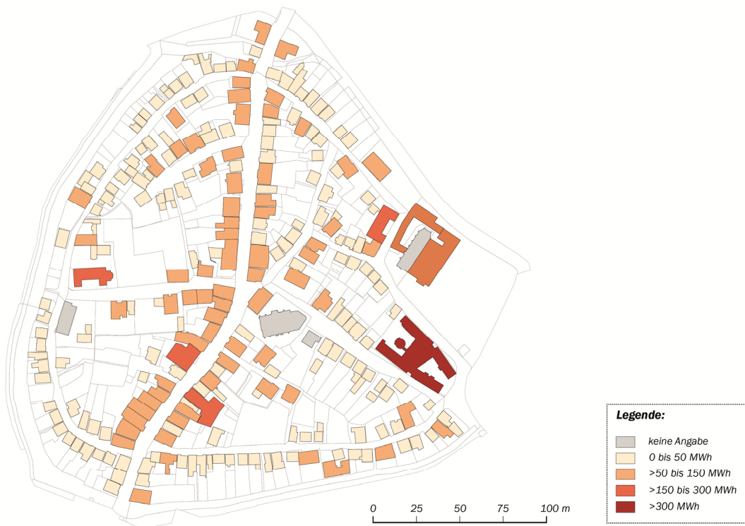
Abbildung 49: Berechnete Wärmedichten im Historischen Stadtkern
