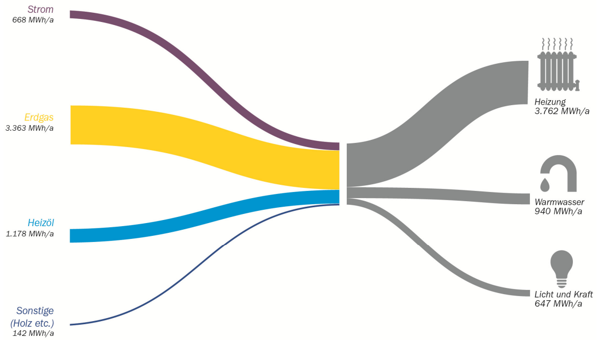
Abbildung 25: Energieflussdiagramm für das Quartier Stennerlandstraße
