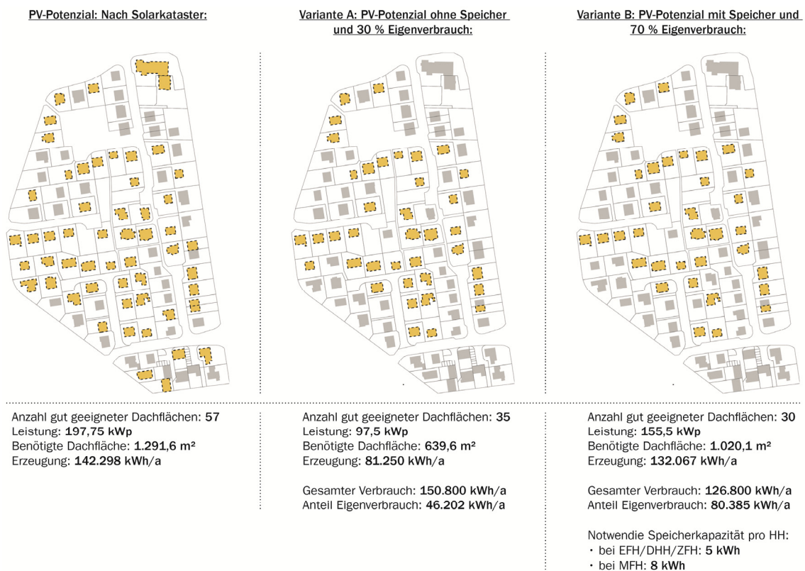
Abbildung 51: PV-Potenzial nach Solarkataster und Simulationsergebnisse der Varianten A und B
